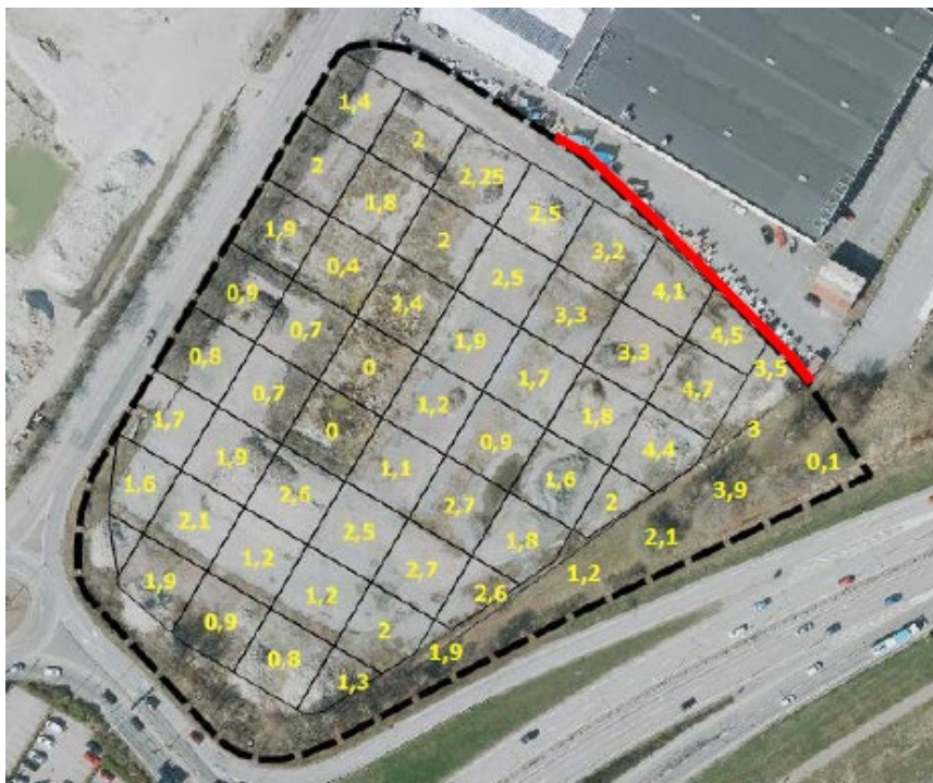
Beräknade ungefärliga genomsnittliga schaktdjup för saneringsåtgärden. Röd markering avser läge för permanent stålspons.
